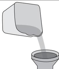
Развести **ДЕКАР** водой (40 °С - 50 °С) в соотношении до 1:15. Заполнить систему рабочим раствором на 2/3 от максимального объема.
