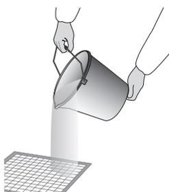
После окончания промывки слить рабочий раствор, промыть систему проточной водой в течение 15 мин.
