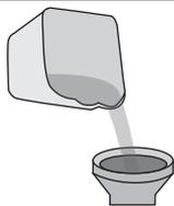
Заполнить внутренние ёмкости на 2/3 от максимального объема рабочим раствором **КЭЛСИ**, разведенным водой (от 1:5 до 1:15).
