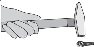
Предварительно обстучать молотком резьбовое соединение.
