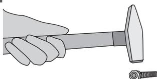
Предварительно обстучать молотком резьбовое соединение.
